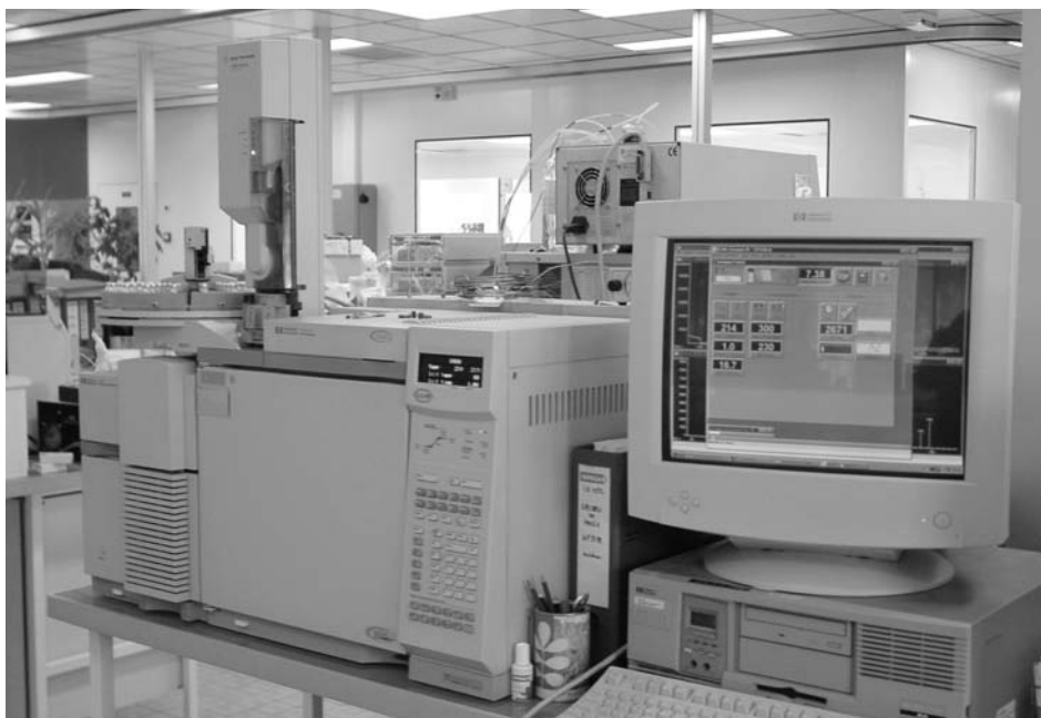
Ensemble de chromatographie gazeuse couplée à la spectrométrie de masse (CPG/SM) Photo prise au Laboratoire Pasteur Cerba.
