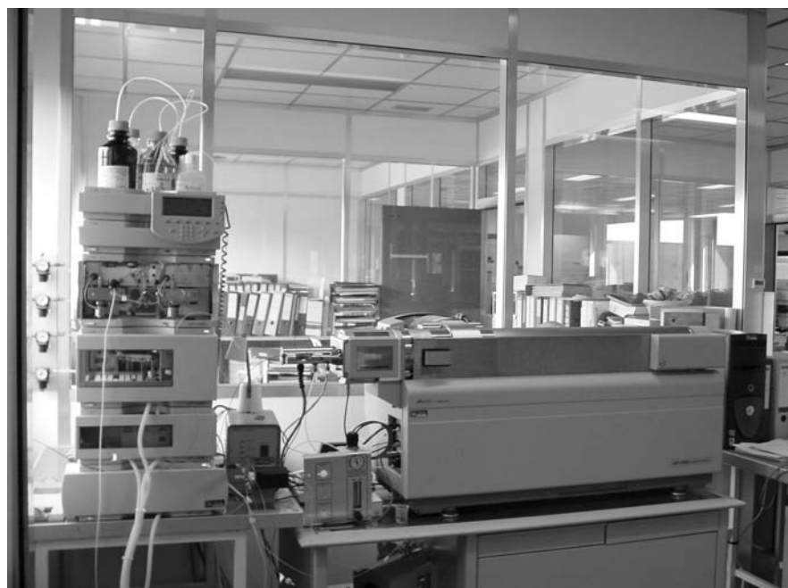
Chaîne de chromatographie liquide couplée à un spectromètre de masse en tandem (LC/MSMS). Photo prise au Laboratoire Pasteur Cerba.
